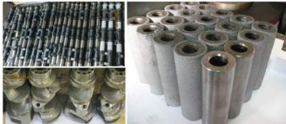
Відновлені деталі: колінвали, розподільчі вали та поршневі пальці двигуна УТД-20
