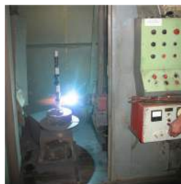
Процес напилення покриття на корінні шийки розподільного вала
