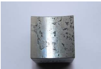
Внутрішня поверхня танкового ствола за використання неякісної сталі
