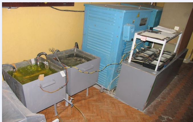
Установка для плазмоелектролітного оксидування (ПЕО)
