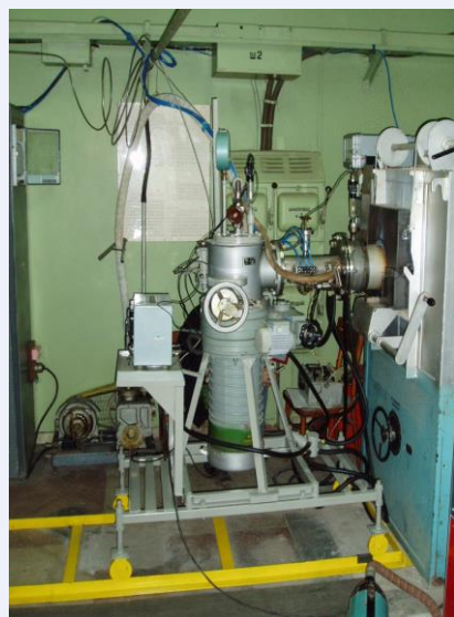
Установки для термічної обробки в вакуумі та контрольованих газових середовищах
