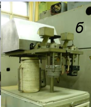
Установки для випроб на малоцикловий чистий згин в широкому температурному діапазоні: 20...600°C (а) та -196...20°C (б) та на втому за циклічного розтягу з асиметричним циклом (в).
