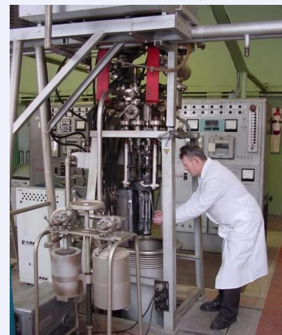
Установки для випроб на тривалу міцність за температурах 20...900°C у безмасляному вакуумі
