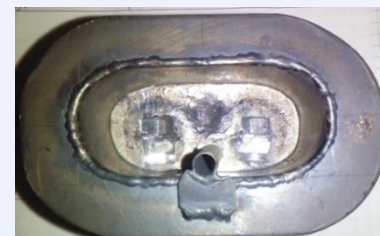
Ванночка зі свинцем для випробувань на малоциклову втому
