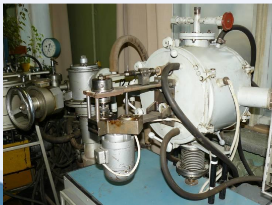
Шестипозиційні установки для випробувань на тривалу та короточасну міцність
