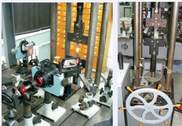
Експериментальна установка для дослідження зразків за навантаження розтягом
