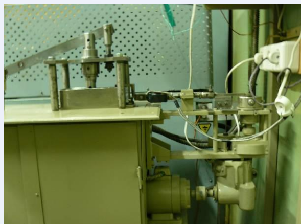
Установка для дослідження поверхні матеріалів при терті ковзанням
