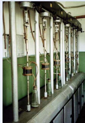
Установки для випробувань зразків на опір корозійному розтріскуванню
