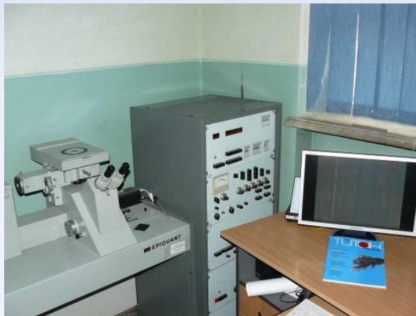
Оптичний мікроскоп "Epiquant" для кількісного та якісного фазового аналізу
