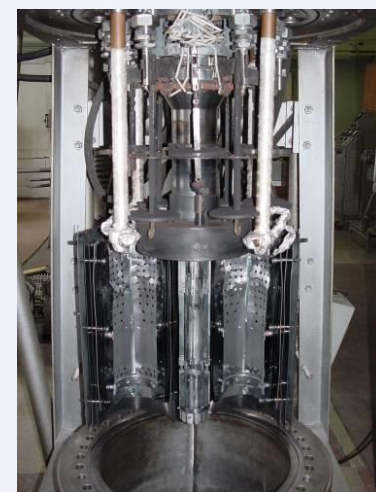
Установки для випроб на тривалу міцність за температурах 20...900°C у безмасляному вакуумі
