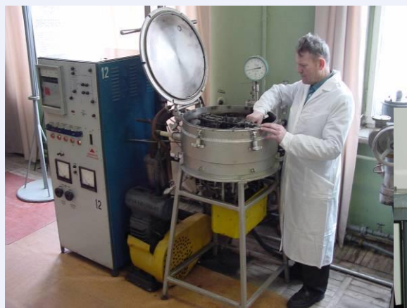
Машина для випроб на малоцикловий чистий згин у вакуумі та газових середовищах (Ar, He, N 2 ).
