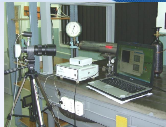
Переносний оптико-цифровий спекл-корелятор у складі експериментальної установки для дослідження пружно-пластичних деформацій біля концентраторів напружень в трубчастих елементах конструкцій
