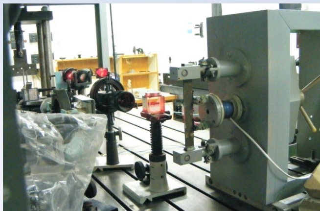
Експериментальні установки для дослідження зразків за навантаження згином
