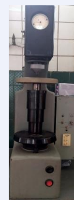
Прилади ТБ-2109 та ТК-2 для виміру твердості методом Брінелля та Роквелла.
