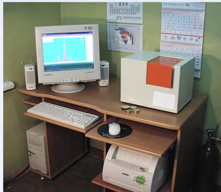
Енергодисперсійний рентгенофлуоресцентний аналізатор «EXPERT 02L»
