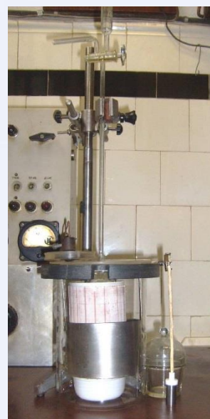
Пристрій для визначення вмісту водню в металах методом анодного розчинення
