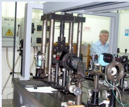
Експериментальні установки для дослідження зразків за навантаження згином
