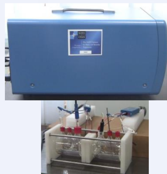
Біпотенціостат Bio-Logic SP-300 та електрохімічна комірка для вимірювання проникнення водню крізь мембрану
