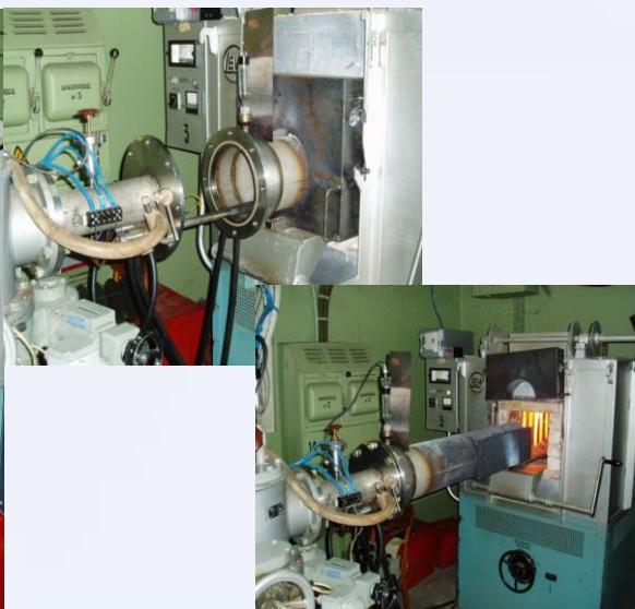
Установки для термічної обробки в вакуумі та контрольованих газових середовищах
