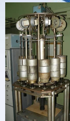
Установка для випроб на тривалу міцність (сповільнене руйнування)
