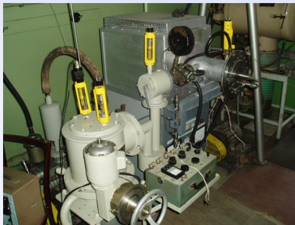
Установки для термодифузійного насичення з порошків у вакуумі та контрольованих газових середовищах
