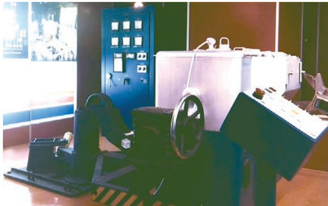
Ливарна МГД- установка для виплавки алюмінієвих сплавів
