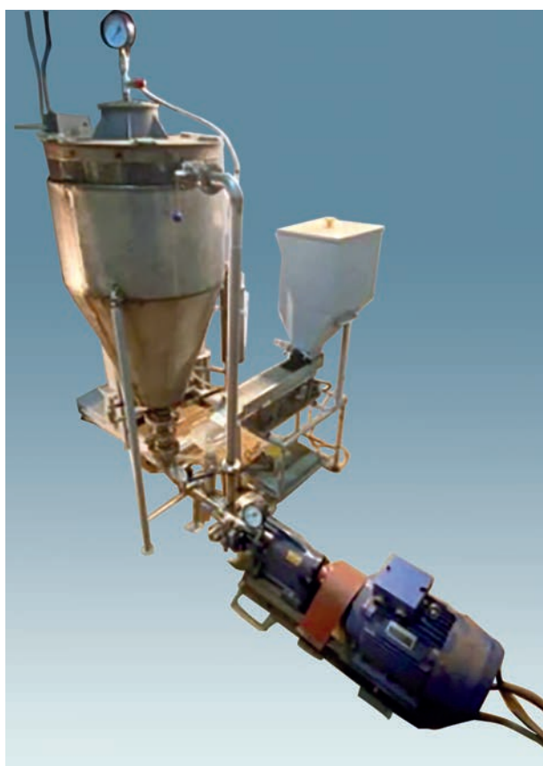
Установка для виробництва паливного біоетанолу з лігноцелюлозної сировини
