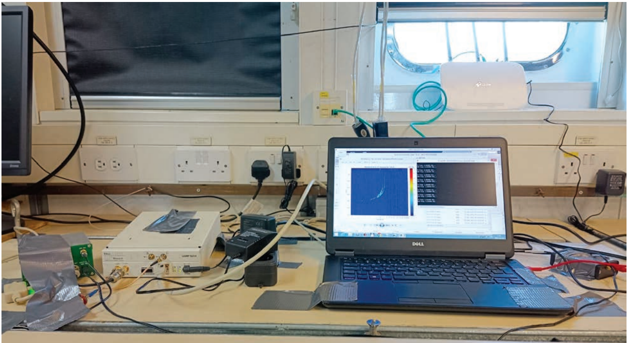
Портативний доплерівський пасивний іонозонд на борту науково-дослідного судна «Ноосфера»
