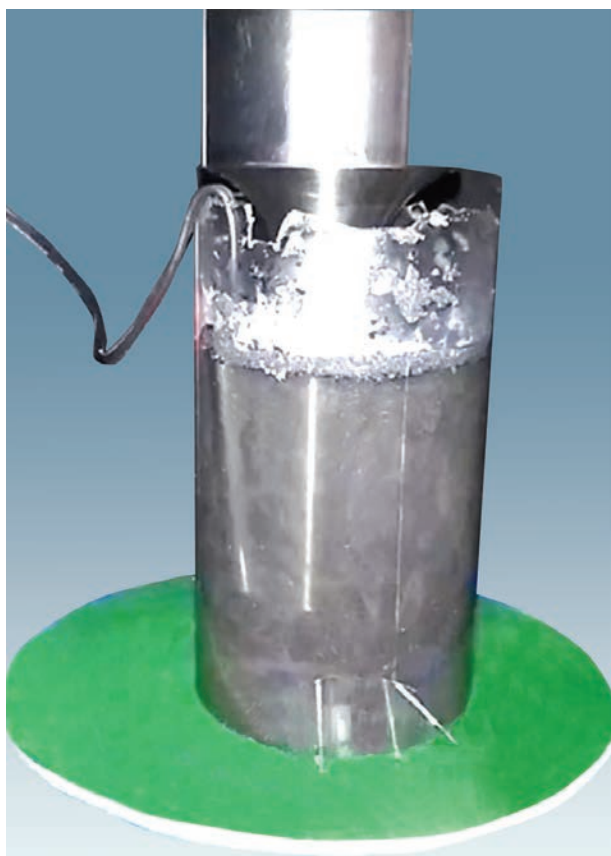
Обробка терморозширеного графіту в ультразвуковому диспергаторі
