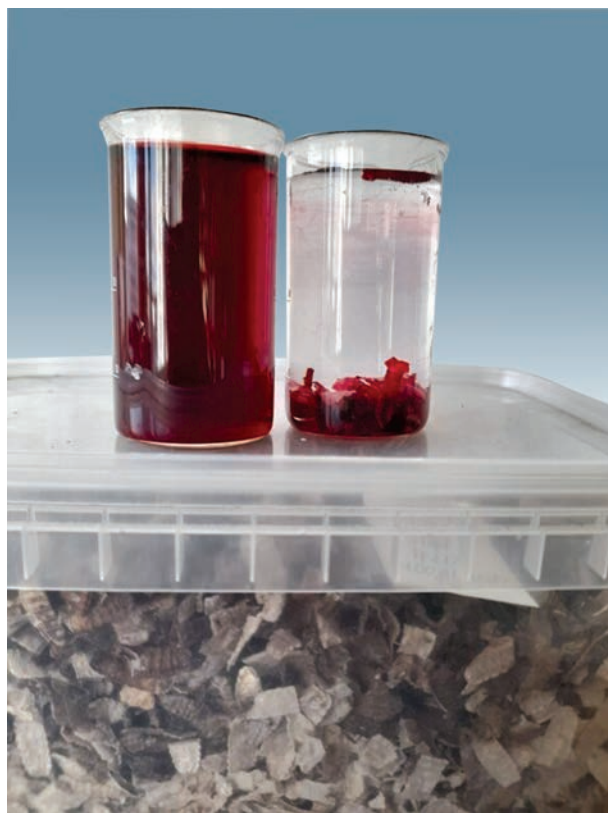
Аланодні стоки, що містять червоний барвник, до та після обробки сорбентом
