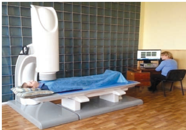
СКВІД-сенсорна магнітометрична система (один з варіантів)
