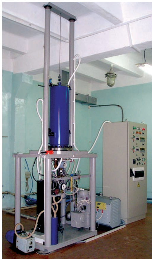
Установка для вирощування халькогенідних кристалів групи A^{IV}B^{VI} за вертикальним методом Бріджмена із надлишковим тиском інертного газу
