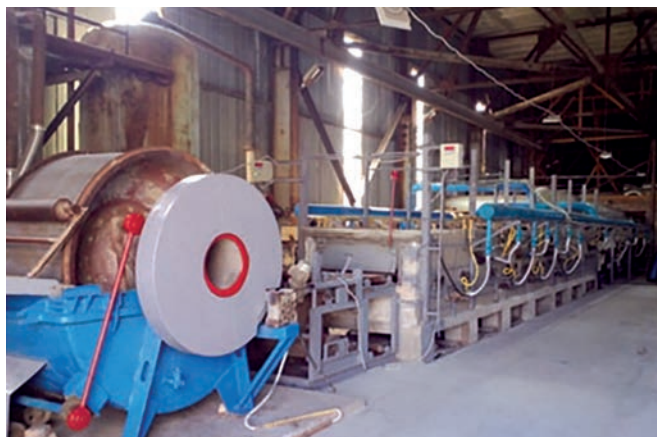
Безперервна технологічна лінія з виробництва базальтового картону
