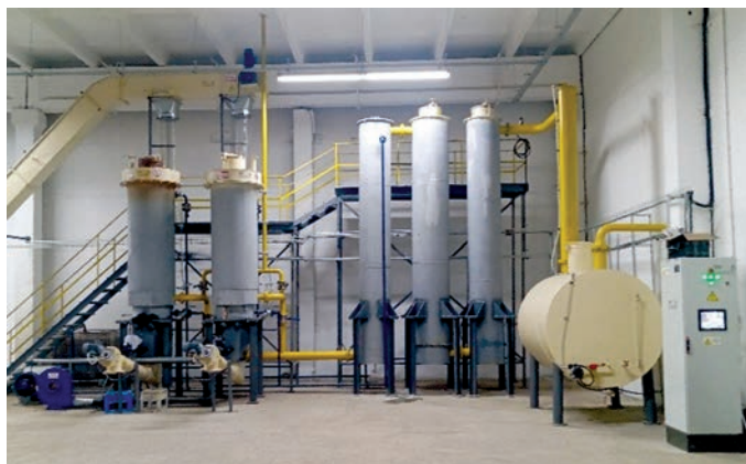
Газогенераторна установка з системою очищення генераторного газу
