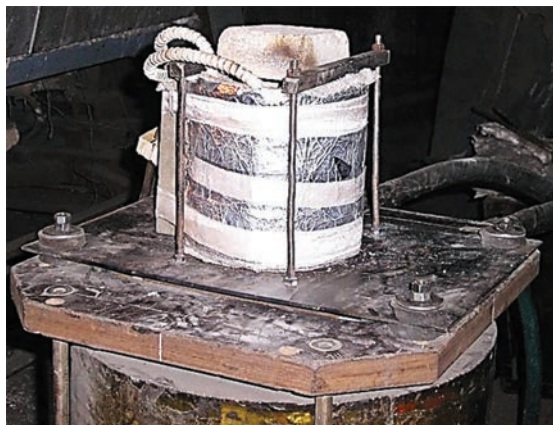
Лабораторна піч з електромагнітним перемішувачем для приготування лігатур
