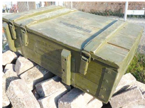
Військова укладка (деревина), захищена ППМ для забезпечення біозахисту та водостійкості
