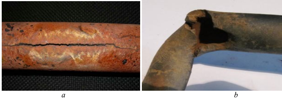
Рис. 2. Зображення крихкого руйнування труб КПП ВТ зі сталі 12X18H10T котла ТПП-210 (a) після напрацювання 243017 h та ТПП-312A зі сталі 12X18H12T (b) після напрацювання 243617 h. Fig. 2. The images of brittle fracture of TPP-210 superheaters boiler tubes (12Cr18Ni10Ti) after 243017 operation h (a) and TPP-312A (12Cr18Ni10Ti) after 243617 h (b).
