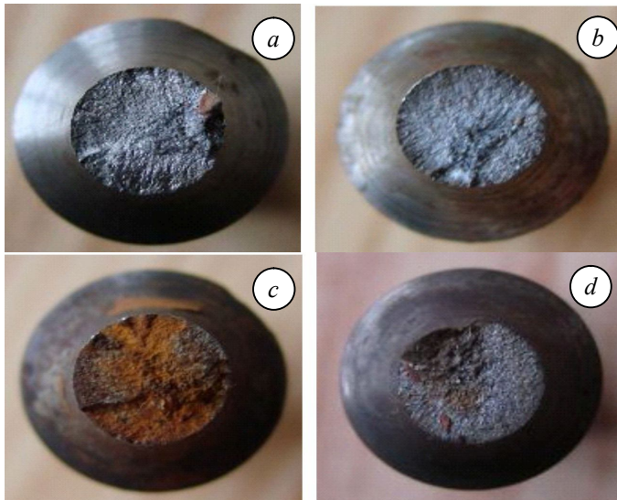
Рис. 6. Втомні злами зразків на повітрі та в корозивному середовищі: контрольний (a, c), витриманий у гідраті (b, d).
